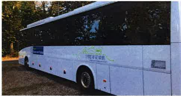
Les bouteilles de gaz naturel se trouvent au-dessus du bus. S'il y a un gros accident, elles s'éjectent à la verticale par sécurité.
